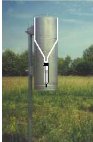
Abbildung 2.4.18: Trichter-Adsorber-Einheit für PAK-Depositionen
