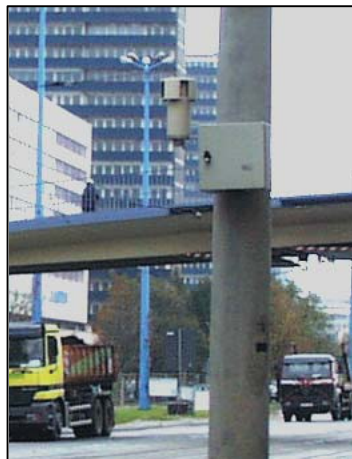
Abbildung 2.6.2: Sigma 2-Halterung für NO 2 -Passivsammler und NUPS für BTX- und Rußbestimmung an einem Lichtmast
